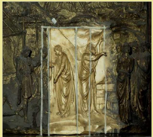
Dal 2002 iniziò un progetto per la messa a punto, con l'IFAC-CNR, di un nuovo ed innovativo tipo di laser per il restauro dei bronzi dorati. Finalmente, dopo la fase sperimentale, si poterono conseguire gli stessi risultati dei bagni chimici senza i rischi connessi con lo smontaggio, come si vede in queste due zone trattate con i due metodi messi a confronto (foto sopra a destra).
