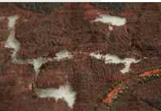
Particolare al microscopio ottico che evidenzia il degrado di alcune zone del tessuto.
